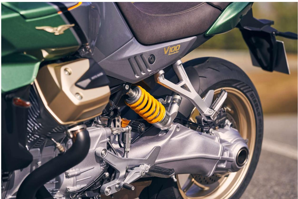
V100 マンデッロのスポーティな個性は、新型エンジンの性能だけではなく、コンパクトで扱いやすいシャーシの特性にもあります。コーナーや高速セクションでのエキサイティングな走りに加え、長距離走行での優れた安定性、そして走る楽しみや喜びの代名詞である独特的のフロントホイールのフィーリングを提供します。スチール製チューブフレームは、モト・グッツィの卓越した製造技術の結晶であり、ホイールベースを 1486mm に設定し、俊敏性も生み出しています。
