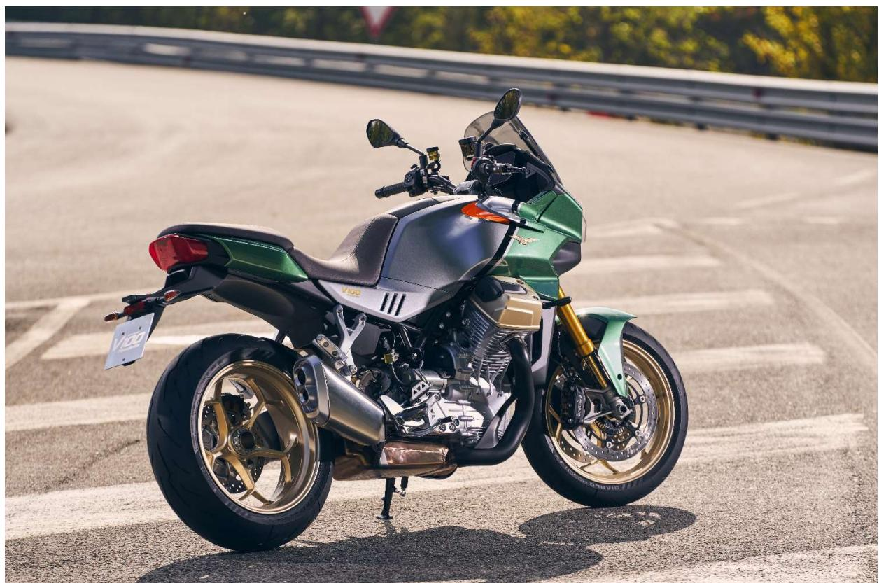
モト・グッツィ V100 マンデッロの開発は、ブランドの歴史におけるターニングポイントとなる、極めて重要な技術革新をもたらしています。アダプティブ・エアロダイナミクスを採用した最初のモーターサイクルであり、6 軸慣性プラットフォーム、コーナリング ABS、セミアクティブサスペンション、クイックシフトなどの高度な電子ソリューションを搭載した最初のモト・グッツィです。また、洗練された技術特性を持つ新型「コンパクトブロック」エンジンを搭載した最初のモト・グッツィとなります。独自のトルク伝達とモト・グッツィ独特のサウンドを実現する 90° 縦置き V 型ツインエンジンは伝統を重んじていますが、完全に新しいプロジェクトとなっています。
